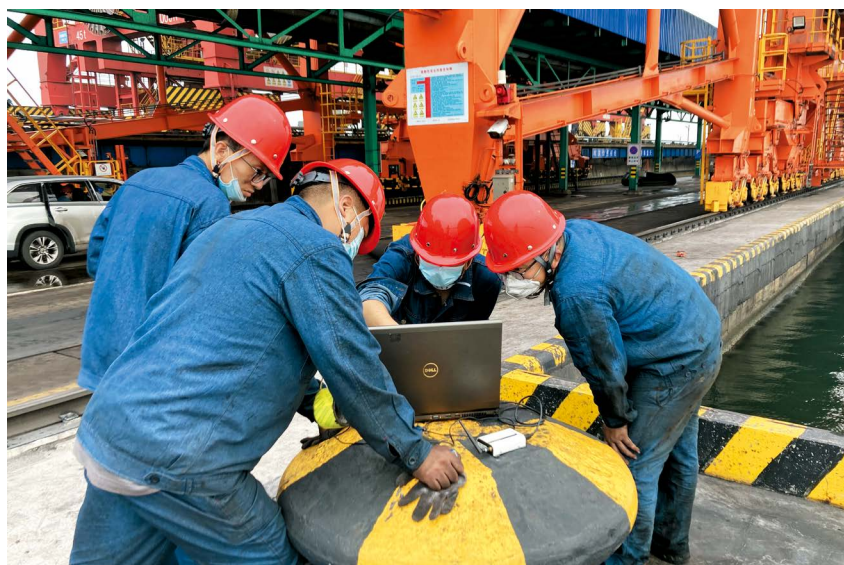
● 2022 年 8 月 5 日，港口装卸设备装船机轮压均衡性测试在秦皇岛港股第六分公司进行 熊健提供
