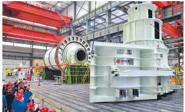
◎ 2022年3月16日，中信重工生产的特大型高端矿山装备GM220-180高压辊磨机、直径6.4×11.15米球磨机、CSM-2250立式搅拌磨等在车间试车并交付客户
