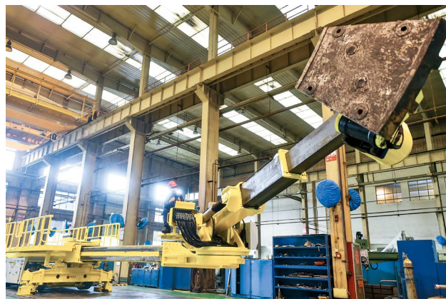
● 2022年10月20日，国产抓取重量最大、悬臂行程最长的新一代七轴重载液机械臂试车下线 中信重工提供
