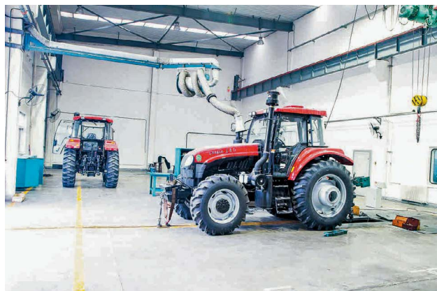
● 洛阳西苑车辆与动力检验所有限公司开展拖拉机液压悬挂试验 市工信局提供
