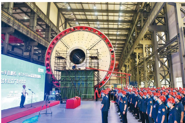
● 2022年9月2日，超大型直径11×5.4米矿用半自磨机、直径7.9×13.6米矿用球磨机下线 中信重工提供
