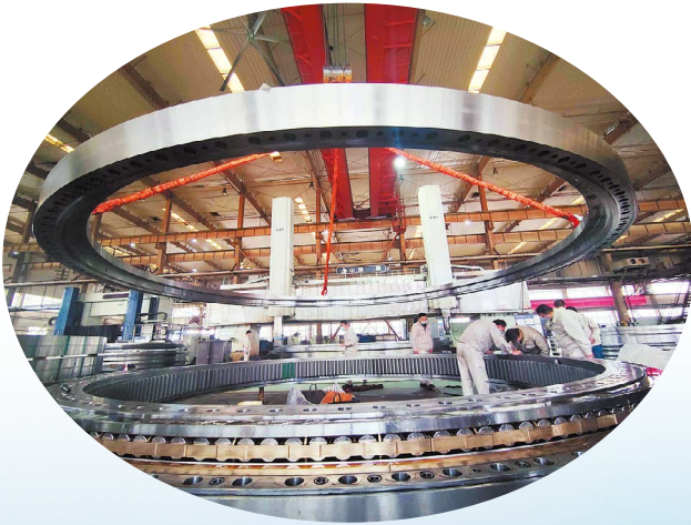
◎ 2022年11月，国内首套自主研发的12米级盾构机主轴承在LYC轴承有限公司下线
